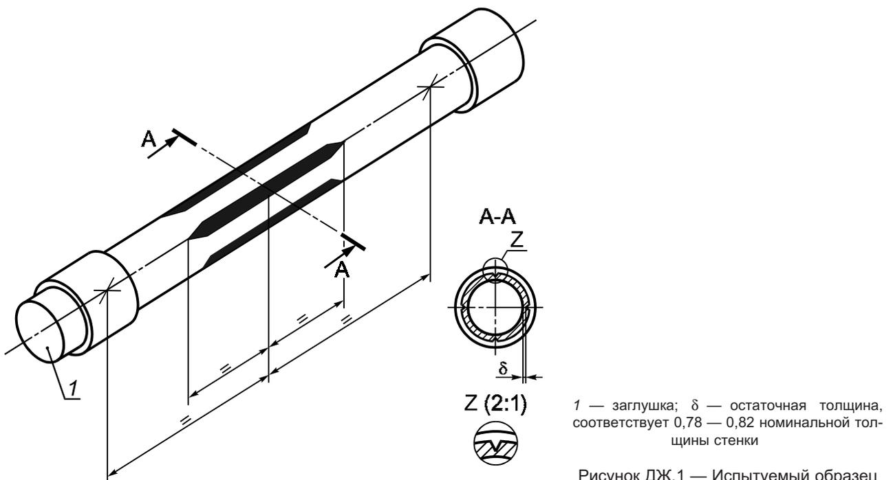
1 — заглушка;  $\delta$  — остаточная толщина, соответствует 0,78 — 0,82 номинальной толщины стенки
