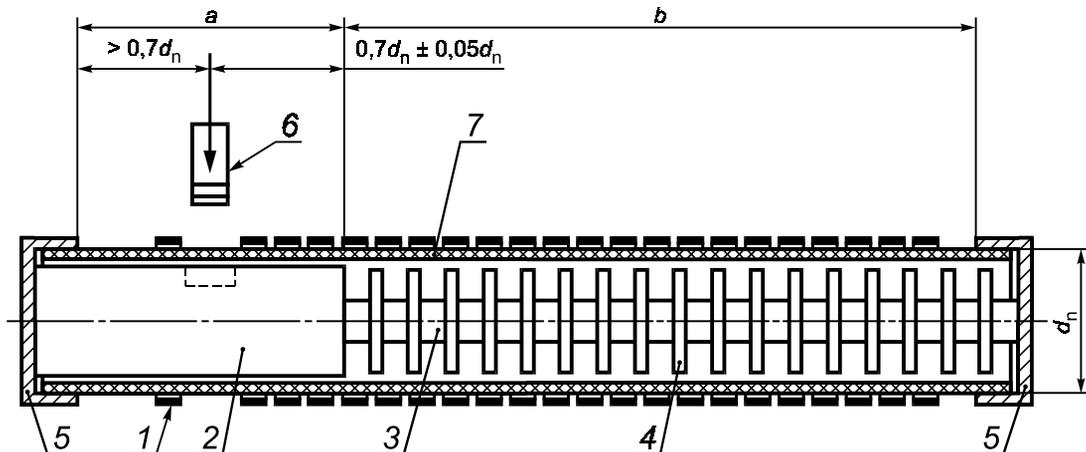
$a$  — зона инициирования;  $b$  — рабочая зона  $> 5d_n$ ; 1 — кольца наружной обоймы; 2 — наковальня; 3 — несущий стержень; 4 — декомпрессионные перегородки; 5 — заглушки; 6 — боек; 7 — испытуемый образец
